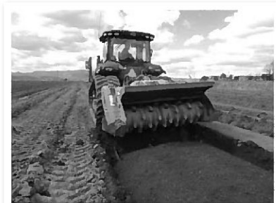
除礫工ストーンクラッシャー作業状況
